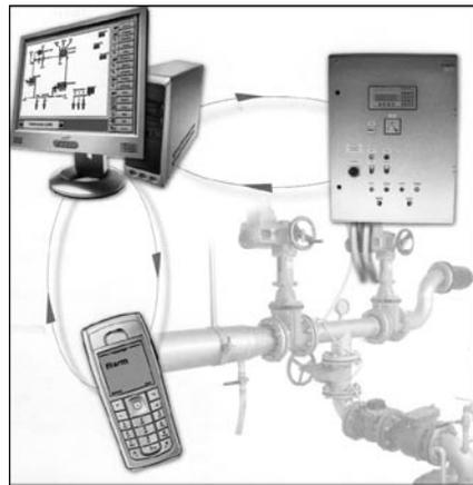
Die letzten 3 Jahre hat sich das Unternehmen intensiv mit der Steuerung und Überwachung von Trinkwasseranlagen beschäftigt. Das „Water Control System“ übermittelt Daten von Trinkwasseranlagen mittels Funk oder GSM an eine zentrale Verwaltungsstelle.
